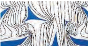
Verlauf der Spannungslinien bei Gusseisen mit Lamellengrafit (links), mit Kugelgrafit (rechts)
